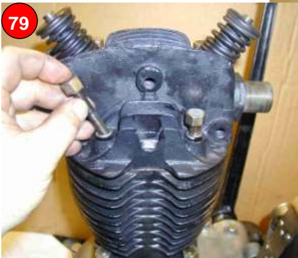
Zylinderkopfschrauben aufsetzen und mit 28 Nm
