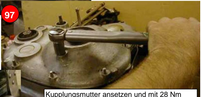
Kupplungsmutter ansetzen und mit 28 Nm anziehen
