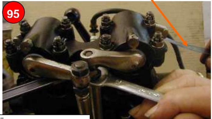
Einsatz einer neuen Dichtung Deckelseite: Maß für Nockenwellenleitlager (siehe Demontageanleitung) ausmessen
