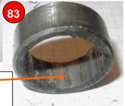
Kontrolle Lagerung Kipphebel: Hier Verschleiß (Kerben) am Einlassventil => neuer Ring (Material 42CrMo4) drehen, härten und schleifen lassen
