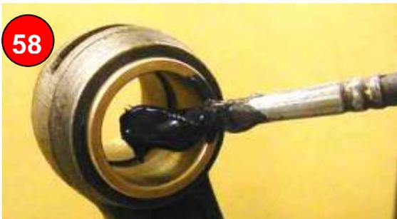
Kolbenbolzenauge und Kolbenbohrung mit Montagepaste (Fa. Fuchs; Gleitmo 100S (MoS2) einstreichen
