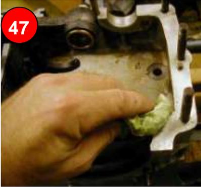
47 Dichtfläche reinigen und mit dauerelastischer hitzebeständiger Silikon -Dichtungsmasse lückenfrei auftragen; hier: Fabr. Berner, Künzelsau, Art. 632236
