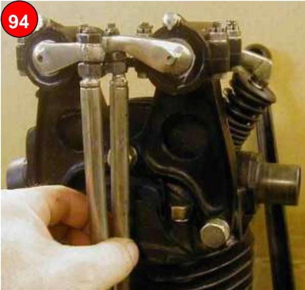
Stößel an den Enden einfetten und einsetzen
